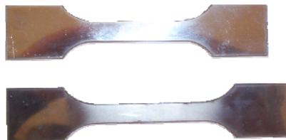
Dans le cas envisagé, on désire simuler un essai de traction simple à l'aide d'éprouvettes plates. On définit une longueur utile initiale (zone où la déformation est homogène avant striction) de  $L_0 = 40$  mm pour une largeur de 12,5 mm et une épaisseur de 2,67 mm.
